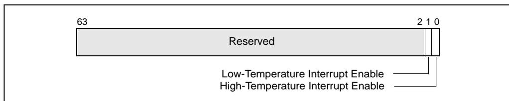
**Figure 13-7. IA32\_THERM\_INTERRUPT MSR**
